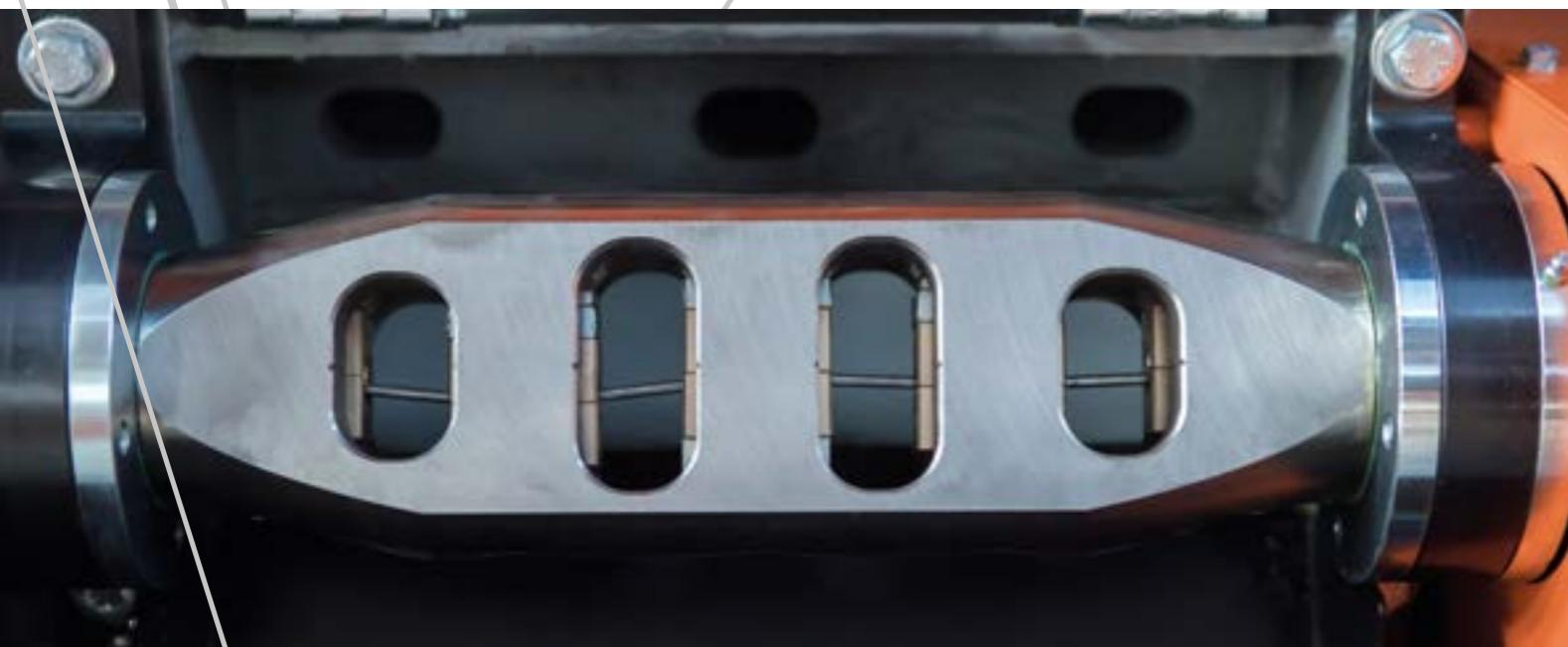
Le rotor atteint un nombre élevé de tours qui permet de gérer différents types de fils en acier entraînés par un servomoteur indépendant. Les fortes vibrations du rotor sont régulées par des roulements de la plus haute qualité et fiabilité. Le rotor avec 5 inserts garantit un redressement excellent. Les inserts de redressement, internes aux rotors et en deux moitiés, sont positionnés d'une manière idéale pour redresser le fil en cours de travail.
